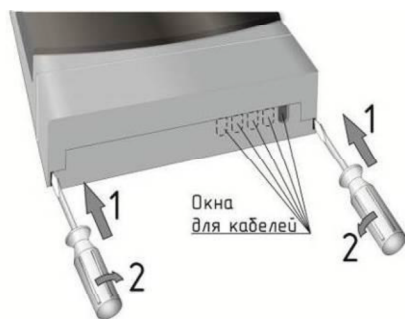
Рисунок 4 – Снятие крышки клеммного отсека
