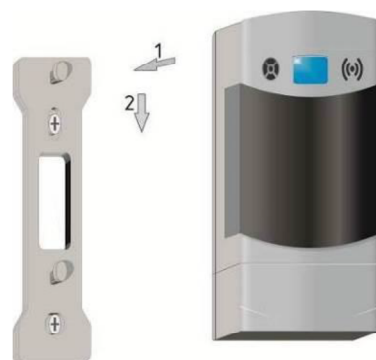
Рисунок 5 – Установка сигнализатора на монтажную панель
