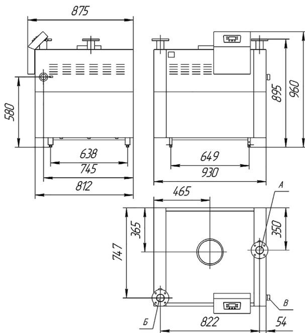
**Рис. 2.2. Габаритные и присоединительные размеры котлов Clever L80, Clever L90**
