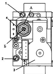
1. Штуцер газового клапана для измерения давления на горелке
