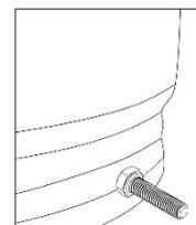
5.4. Водонагреватель необходимо подключить непосредственно к водопроводной сети с давлением не более 6 бар. Минимальное давление не должно быть меньше 2 бар. Труба подачи холодной воды должна присоединяться через предохранительный клапан на 6 бар, расширительный бак системы ГВС не менее 10 литров (10% от объема контура ГВС).
